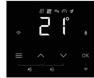
7 segmentli LED ekran ve dokunmatik butonlar
